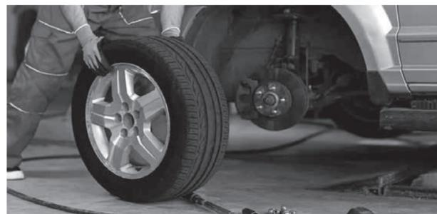
responder adequadamente aos comandos do motorista. Portanto, é importante trocar os pneus antes que eles atinjam o limite mínimo de desgaste da banda de rodagem. “Fique atento aos sinais de desgaste, como barras de desgaste, niveladas com a banda de rodagem ou fios aparecendo nos pneus”, disse.
