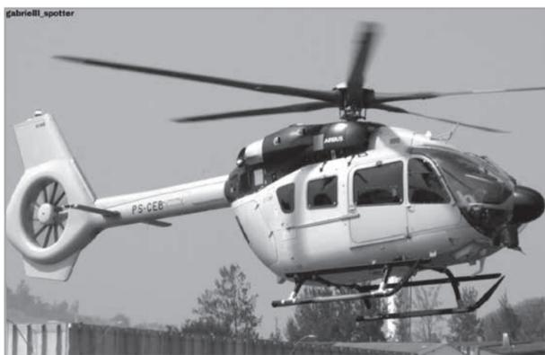
H145 D3 é um robusto biturbina, com capacidade para dois tripulantes e 9 PAX (9 passageiros), podendo ser configurado para busca e salvamento, além do kit EMS (Emergency Medical Service), convertendo a aeronave numa “ambulância aérea” em questão de minutos. O Kit EMS refere-se aos equipamentos que compõem a configuração aeromédica, como maca e sistema de monitoramento de sinais vitais.
