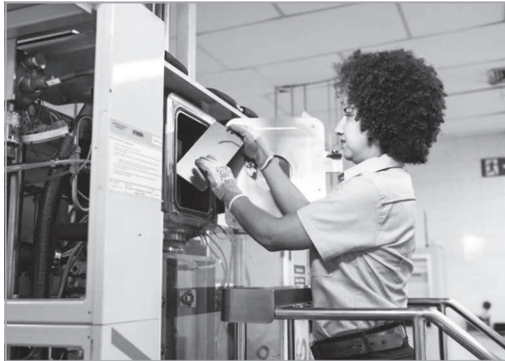
Os investimentos também possibilitaram a aquisição de um novo módulo de controle de umidade, aumentando a precisão das simulações laboratoriais e aproximando os ensaios das condições reais dos processos industriais (Foto: Divulgação)
